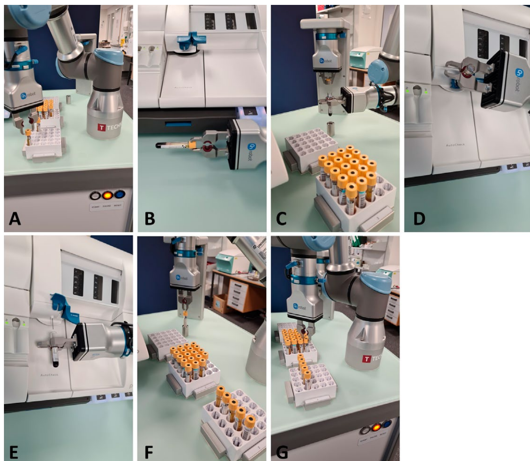
Figur 2: Robot-armen tager prøve fra start-rack (A) og skanner prøvens stregkode (B). Herefter afproppes prøverør (C), og robot-armen åbner ABLs inlet (D). ABL aspirerer prøvemateriale (E), og robot-armen lukker inlet igen. Herefter sørger robot-armen for at sætte proppen tilbage på prøverøret (F), og prøven placeres i rack for færdiganalyseret prøve (G) eller i rack for prøve til manuel håndtering.
