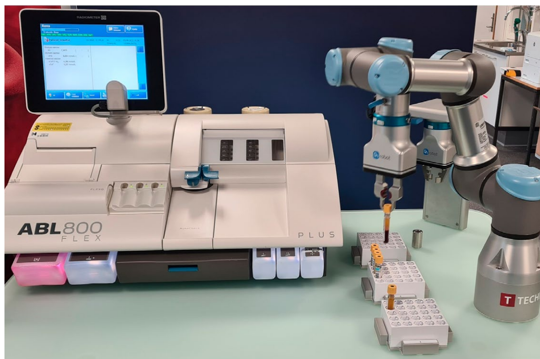
Figur 1: ABL800 med robotløsning (Radiometer og Technicon).
