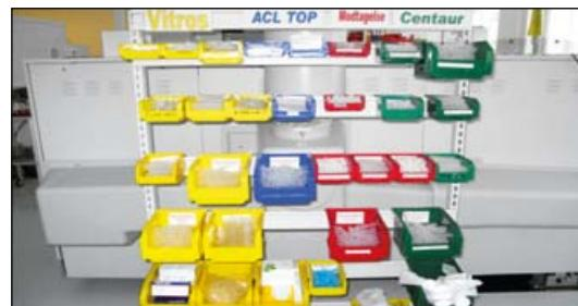
**Figur 12:** Lean-reolen, der indeholder fyldte reservekasser for de kasser, der står på de enkelte arbejdsstationer. Reservekassene holdes altid fyldte.
