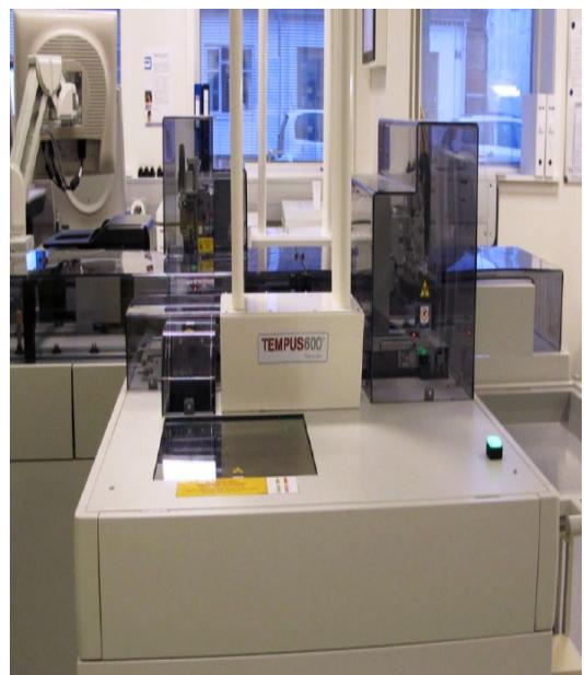
Figur 3. Bulkloader med Tempus
