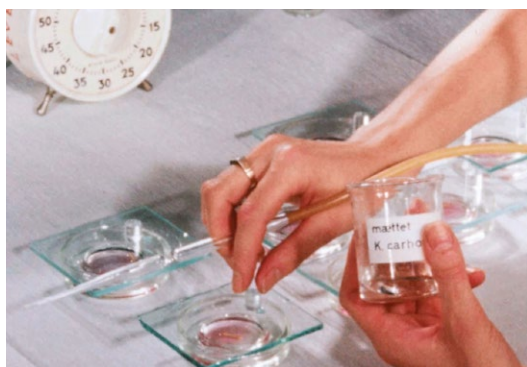
Figur 5. Bestemmelse af carbamidkoncentrationen med Conway metoden. (Centrallaboratoriet i funktion, Klinisk Film a/s)
