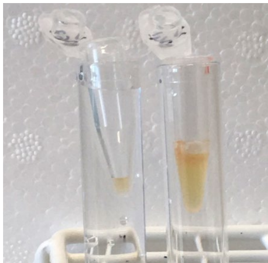
Bild av rör med vatten i ytterröret till vänster och rör utan vatten till höger. Vätskenivån i ytterröret är knappt skönjbar.
