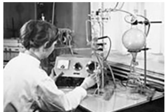
Figur 2: Astrup Apparatus E50101 fra Radiometer til måling af blodgasser og syre/base status.
