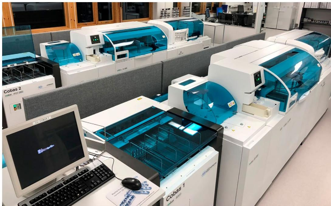
De to instrumentlinjene med valideringsrom i bakgrunnen. De grå veggene bak instrumentene er støyskjermer, og er et av flere støyreduserende tiltak.
