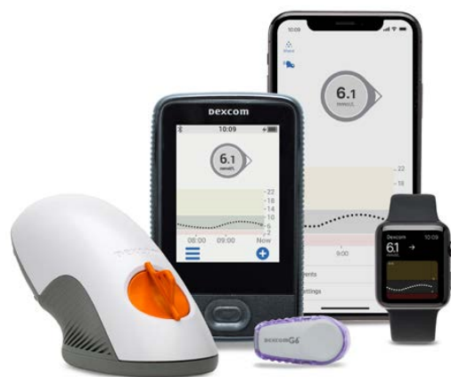
Figur 1. Ved hjælp af en inserter (nederst til venstre) påsættes sensor og transmitter (nederst i midten) på huden. Sensordata sendes til en modtager, som kan være enten en smartphone, smartwatch eller egentlig modtagerenhed, hvor sensordata ses. Denne model er Dexcom G6.
