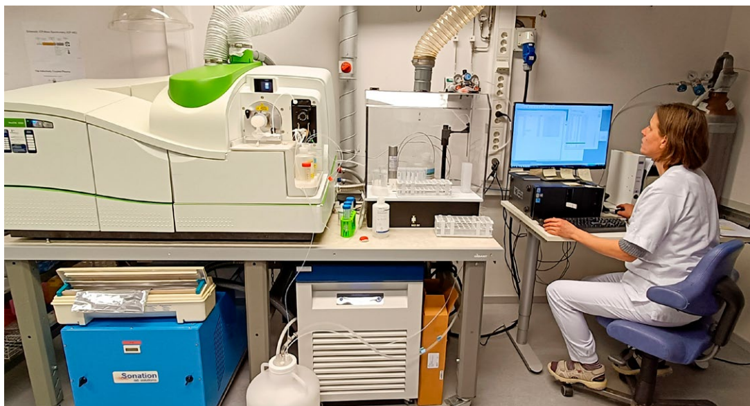
Figur 4. Spesialingeniør Arntraut Götsch holder på med analyse av tungmetaller og sporelementer på induktiv-koblet-plasma massespektrometer (ICP-MS). På dette instrumentet analyseres både prøver til forskning og klinisk diagnostikk. En del analyser er akkrediterte i henhold til NS-EN ISO 15189:2022.
